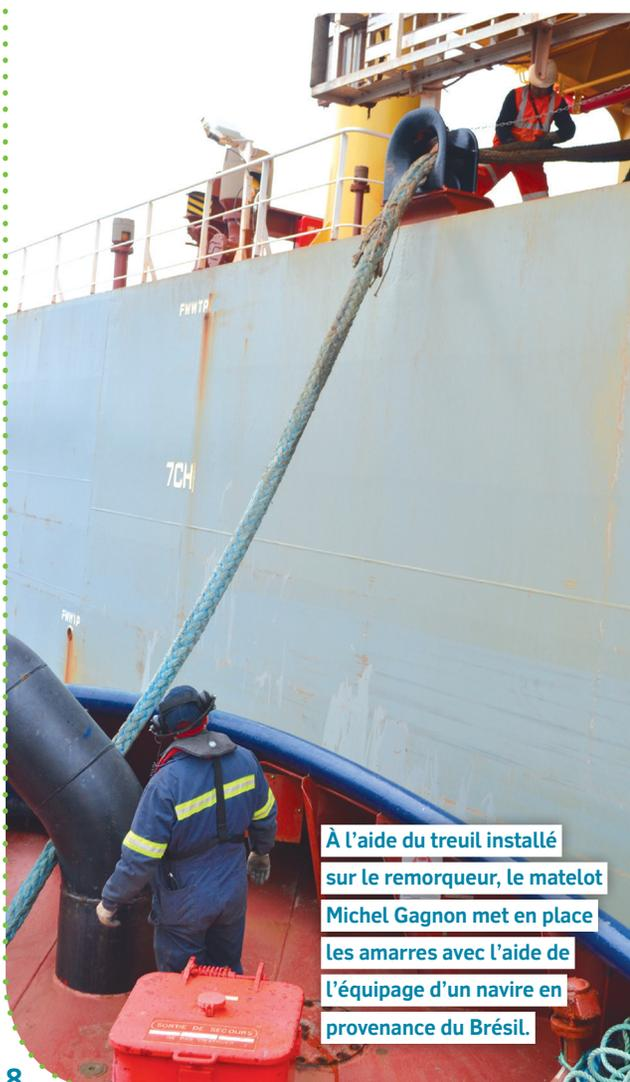
À l'aide du treuil installé sur le remorqueur, le matelot Michel Gagnon met en place les amarres avec l'aide de l'équipage d'un navire en provenance du Brésil.
