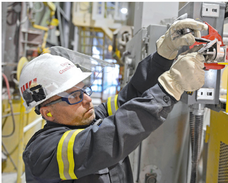
Un opérateur procède au verrouillage du creuset à l'aide du système anti-erreur.
