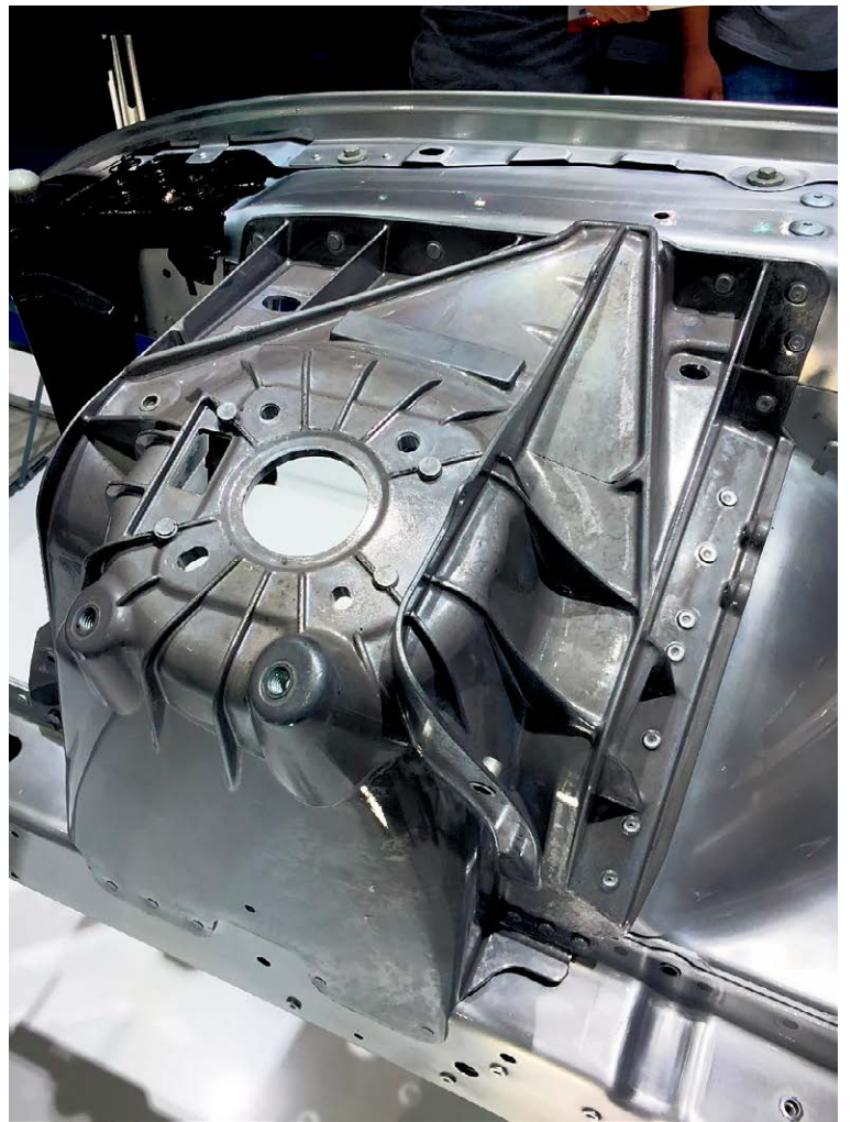
Coupelle d'amortisseur, alliage de fonderie produit à Beauharnois.
