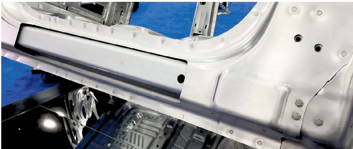
Feuille d'aluminium estampé, alliage produit à Laterrière.
