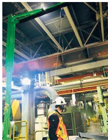
La potence amovible avec rail et enrouleur-dérouleur qui permet d'assurer la sécurité sans nuire à la liberté de mouvement des travailleurs.
