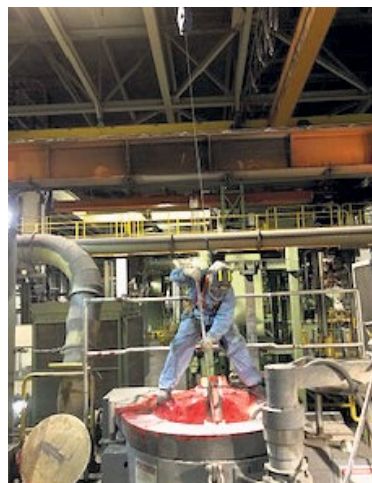
La potence amovible avec rail et enrouleur-dérouleur qui permet d'assurer la sécurité sans nuire à la liberté de mouvement des travailleurs.
