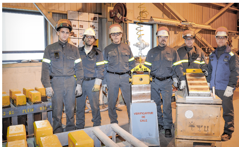
Les opérateurs de l'atelier des services à l'électrolyse inspectent les cales après chaque utilisation.
